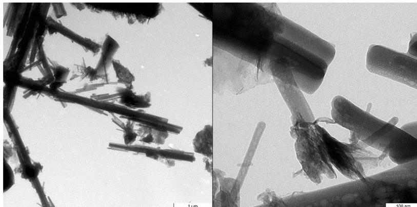
Рис. 2. ПЭМ-микрофотография частиц МПГ (2 % сахарозы)
