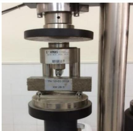
Рис. 5. Определение прочности образцов на растяжение при изгибе
